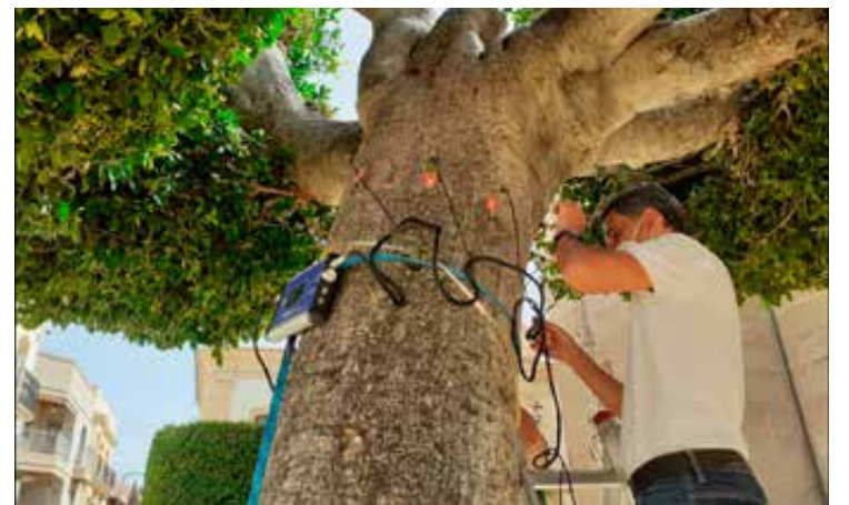
Instalación de electrodos en árboles
